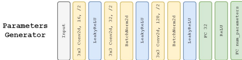
Fig. 3. Parameter generator architecture.
